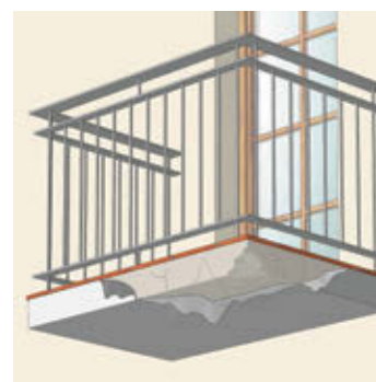
Uszkodzenia płyty balkonowej...
