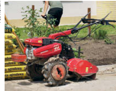
Ciągnik F560 z zestawu Multipro z tylnym agregatem glebogryzarki sprawdza się w pracy na wąskich pasach zieleni wokół bloku. Szerokość robocza – 60 cm. Cena z agregatem: 13 459 zł
