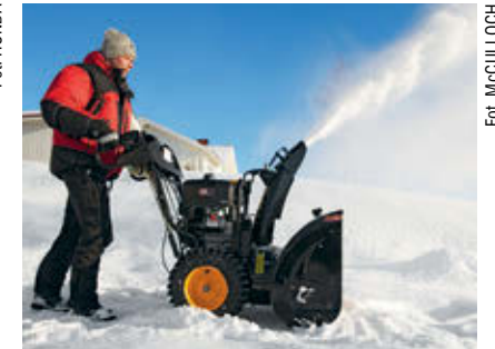
Odśnieźarka spalinowa PM 105 z elektrycznym rozrusznikiem, dwustopniowym rodzajem dmuchawy, moc 7,5 kW i 3600 obrotów/min. Cena: 6499 zł
