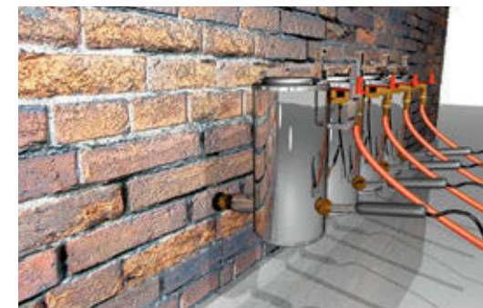
Zamocowanie termopakerów w murze
