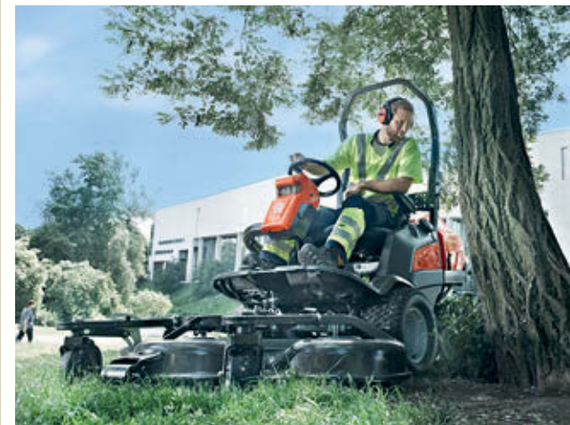
Rider P 525D – wielofunkcyjna kosiarka z napędem na cztery koła i hydrostatyczną przekładnią. Zamontowane z przodu urządzenie tnące umożliwia obserwację pola pracy oraz koszenie trawy w miejscach trudno dostępnych. Można do niej dołączyć na przykład tyłkę czotową, szczotkę, lemiesz składany lub kabinę. Cena: 76 799 zł
